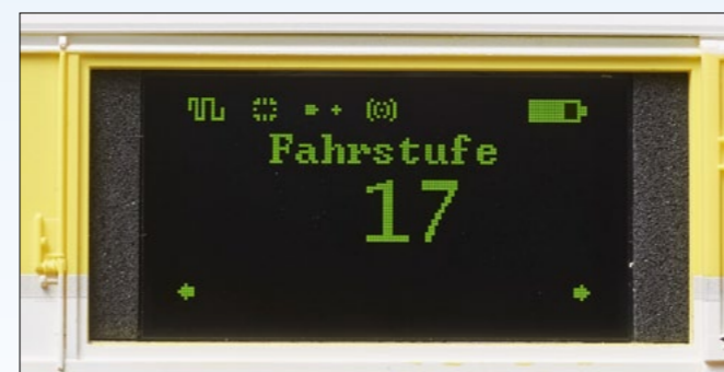
Über die PC-Software kann eingestellt werden, von welcher Lokadresse die Fahrstufen mitgelesen werden sollen.
