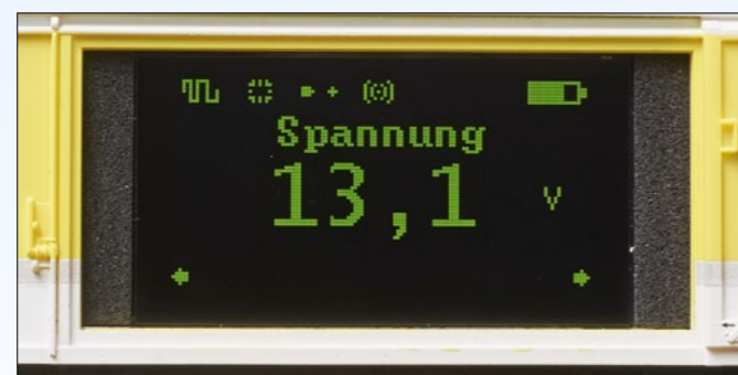
Hier wird im Display angezeigt, dass am Gleis eine Digitalspannung (Symbol links oben im Display) von 13,1 V anliegt.
