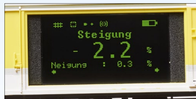
Hinsichtlich der Betriebssicherheit können die Werte von Steigung und Neigung beim Abfahren der Strecke aufschlussreich sein.
